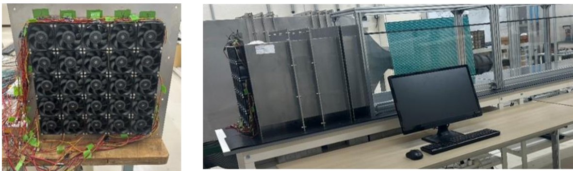
図1 小型マルチファン型風洞（左：マルチファンユニット，右：試験部）
