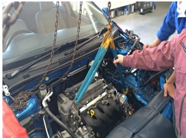
図7 エンジン吊り上げ
