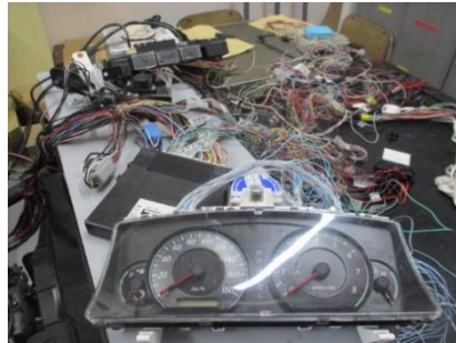
図 11 メータ周りの配線作業
