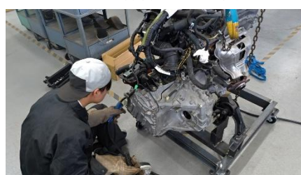
図 16 マウント部の溶接
