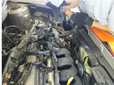
図4 配線、配管の取り外し
