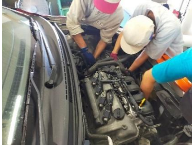
図3 配線、配管の取り外し
