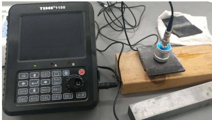
図1. TIME1150 超音波探傷器での探傷の様子
