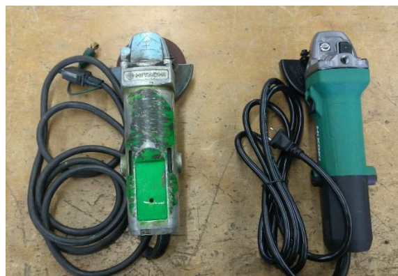
図1. 更新前の高速切断機 図2. 更新後の高速切断機 図3. 更新前と更新後のハンドグラインダー
