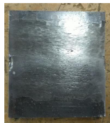
図3. 研磨後のテストピース
