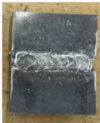
図2. 溶接後のテストピース
