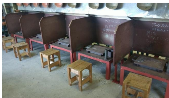
図2. 個別アース仕様の作業台
