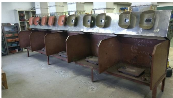
図1. 共通アース仕様の作業台
