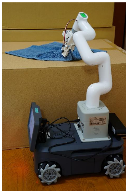
図7 ロボットプラットフォームによる自律移動と柔軟物把持・操作の様子
