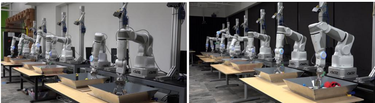
図 1 14 台のロボットアームとグリッパによる物体把持の AI 学習の様子
