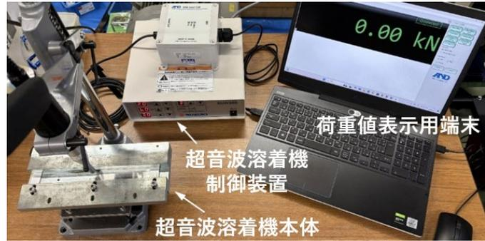
(b) 超音波溶着装置制御系
