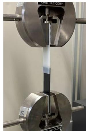
図 5. 溶着継手試験片の引張せん断試験
