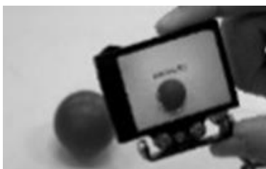
図 1 Huskylens によるボールの認識
