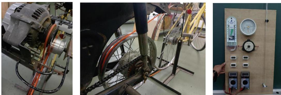
負荷機として自動車用オルタネータを使用し、ゴムベルトで動力伝達をする形とした専用機ではなく汎用性の高い構造で様々な動力機械で使用することができる。
