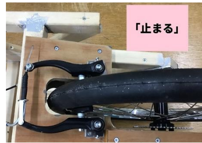
写真 10 Vブレーキ（木製フレーム）
