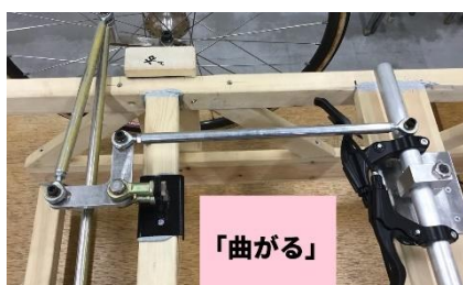
写真7 舵取り装置②(木製フレーム)
