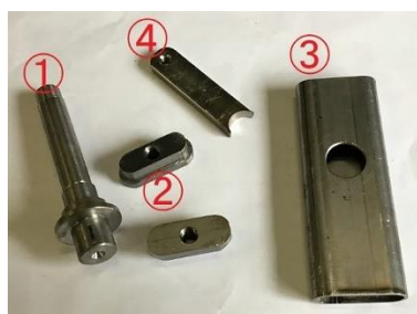
写真8 ナックルアームの構成部品
