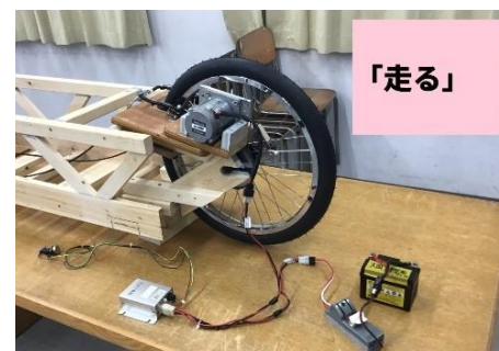
写真5 エコハイモーター取付・コントローラー配線
