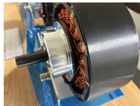
写真6 完成したモーター
