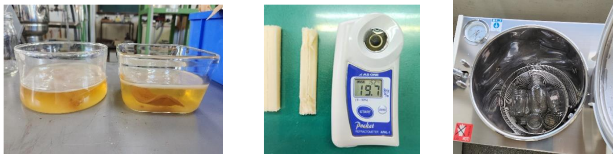
図 1．酢酸菌が膜を生成する様子とサトウキビの糖度測定 オートクレーブによる滅菌
