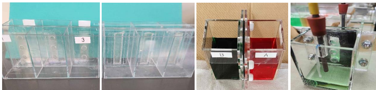
図9 ドリルとレーザーでの穴あけ加工 膜の非交換型と膜の交換型
