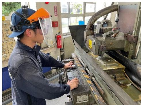
写真4 平面研削盤作業
