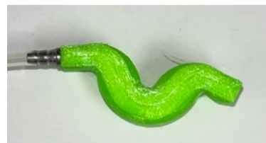
図 16 第 4 試作モデルの空圧による変形
