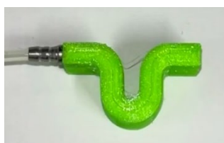
図 16 第 4 試作モデルの空圧による変形
