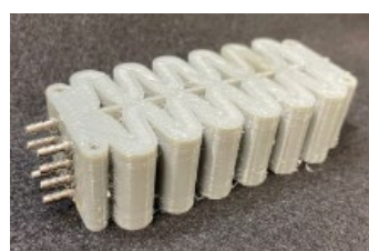
図5 配管を内蔵した第2試作モデル
