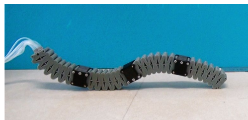
図6 進行波による移動の実現
