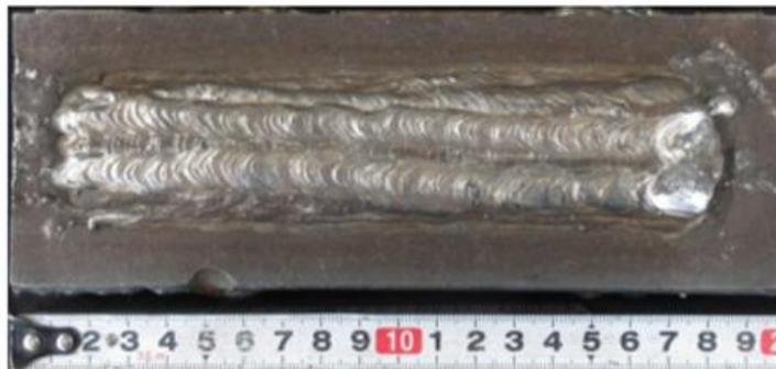
図 2 二相ステンレス鋼溶接棒による肉盛り溶接
