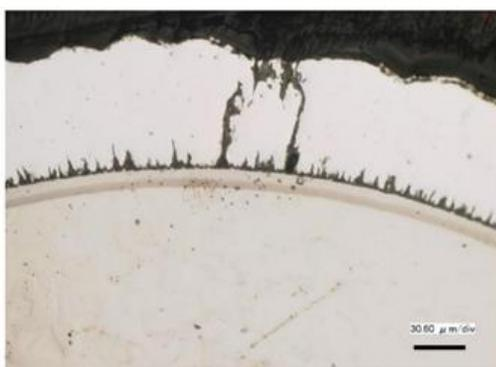
図4 従来の材料の熱処理後の断面
