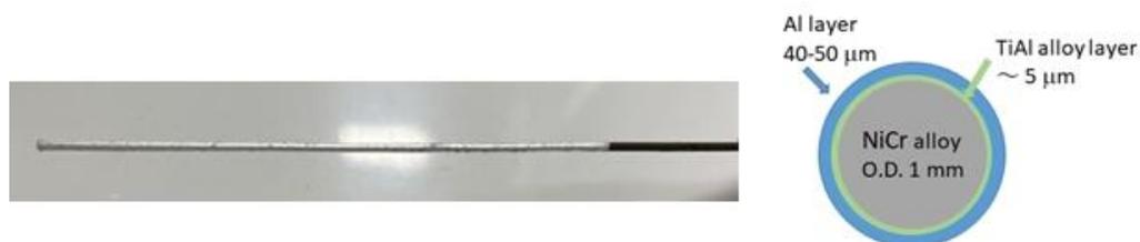
図 2 中間層ワイヤ状材料（左：概観、右：断面イメージ）
