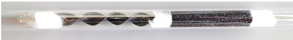
図5 スパイラル型触媒および前段の活性炭層
