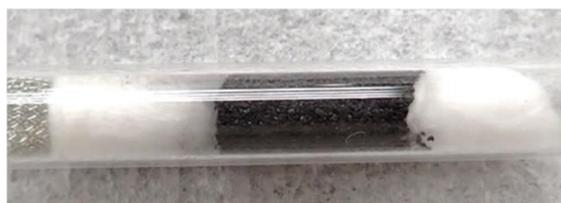
図 1 充填型粒状触媒反応層
