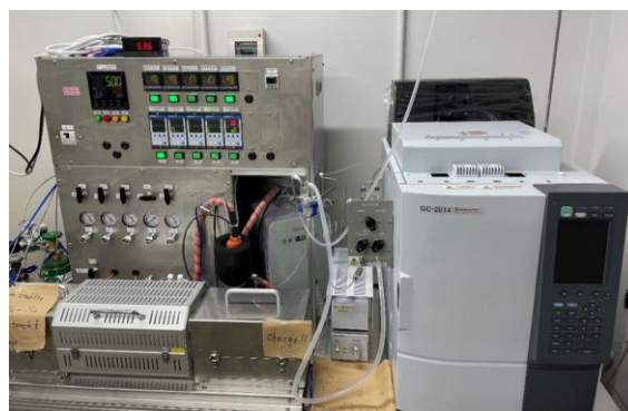
図2. 触媒性能評価に用いた固定床流通式反応装置の写真
