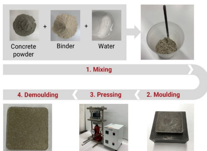
図 1. 水和反応に依存しない硬化体作製の手順
