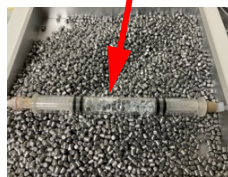
図 8 カラム管に充填されたエステラーゼ固定化 poly(HPMA/AzMA)/Nylon6 不織布と、これを連続流路系にセットした反応系の構築
