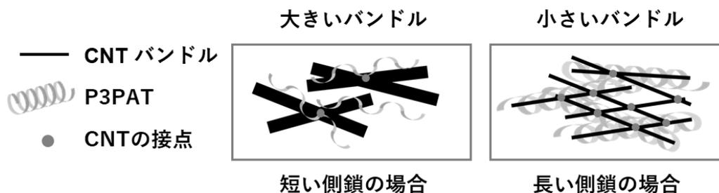
図6. P3PAT/SWCNT 複合薄膜のモルフォロジーのイメージ図
