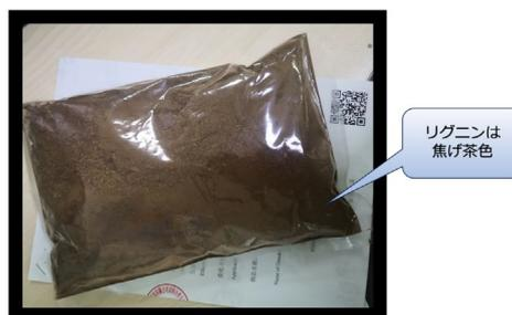
図4 酵素分解によって得られたリグニンの分解物の写真
