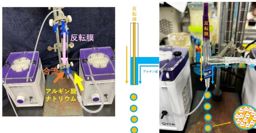
図 3. 二重管ノズルを用いた反転膜包埋アルギン酸ゲル作成装置とその概略図
