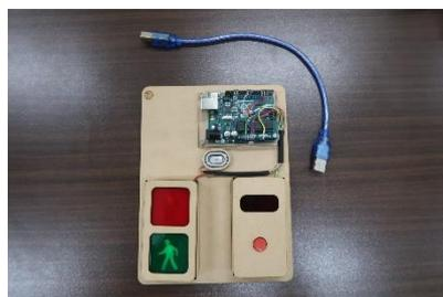
(b) 製作した信号機の模型
