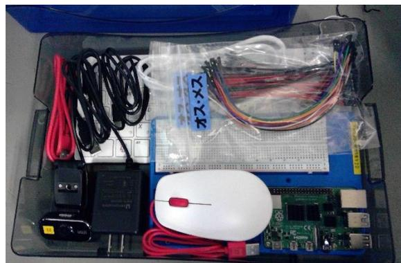
図 2 Raspberry Pi 基礎実習セット
