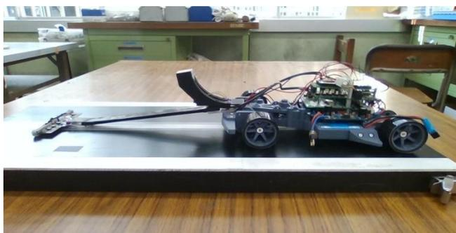
図2. 今回3Dプリンタマイコンカー購入し製作したレーザーセンサー搭載の自動走行ロボット
