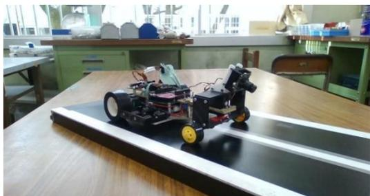
図3. ベーシックマイコンカーキットを改造し、画像処理キットを用いて製作した。画像処理を用いた自動走行ロボット
