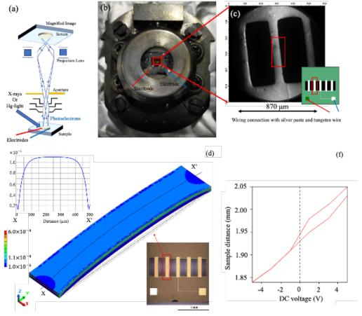
図 8 (a)放射光 PEEM に MEMS を導入した場合のセットアップ概念図.(b)両持ち梁構造 MEMS を PEEM に導入し、(c)梁の一部をイメージングした例.(d)両持ち梁構造 MEMS の電圧歪み特性のシミュレーション結果.(f)イメージング・フォーカスから MEMS 素子の駆動を確認した結果.
