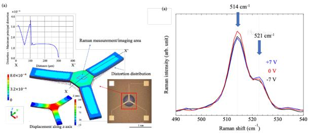
図 7 (a) 3 点引っ張り試験 MEMS 素子の歪み分布シミュレーション結果.(b) 3 点引っ張り試験 MEMS を用いて中央のシリコンのラマンスペクトルを MEMS 素子動作中に測定した結果.
