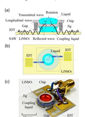
図 5 (a) SAW を用いたマイクロディスポー サブル攪拌器の原理図の断面図. (b) 攪拌 器の上から見た概念図.(c) 実際に作製し たマイクロディスポーサブル攪拌器の光 学写真.
