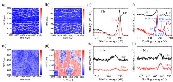
図 4 FEP/Cu 試料における FEP 剥離 Cu 面 mXRF マッピング: (a)炭素(C)と(b)フッ素(F). PFA/Cu 試料における FEP 剥離 Cu 面 mXRF マッピング: (c) C と(d) F. HAXPES 測定結果: (e) F1s, (f) C1s, (g) O1s, (h) N1s.
