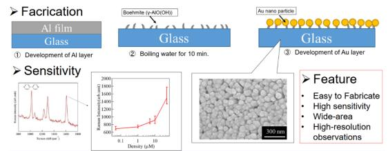
図5①表面増強ラマン散乱活性な貴金属ナノ構造を創製する方法.貴金属ナノ構造体を形成したい領域以外をマスキングして貴金属ナノ構造体を形成したい領域のみにアルミニウムをスパッタする.②沸騰した水に基板を浸漬させて、水酸化アルミニウム構造を形成.③金をスパッタすることで、所望の領域に金ナノ構造を作製できる.表面増強ラマン活性を測定した結果をSensitivityに示す.金ナノ構造の典型的な SEM 観察像.
