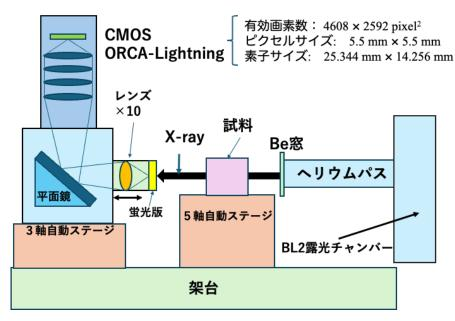
図 1 放射光施設ニュースバル・ビームライン BL2 に設置した間接型 X 線イメージングシステム
