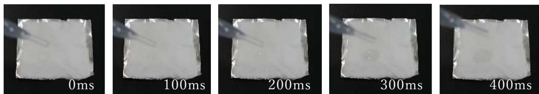
図 5 羽毛模倣構造の吸水性評価時の連続写真
